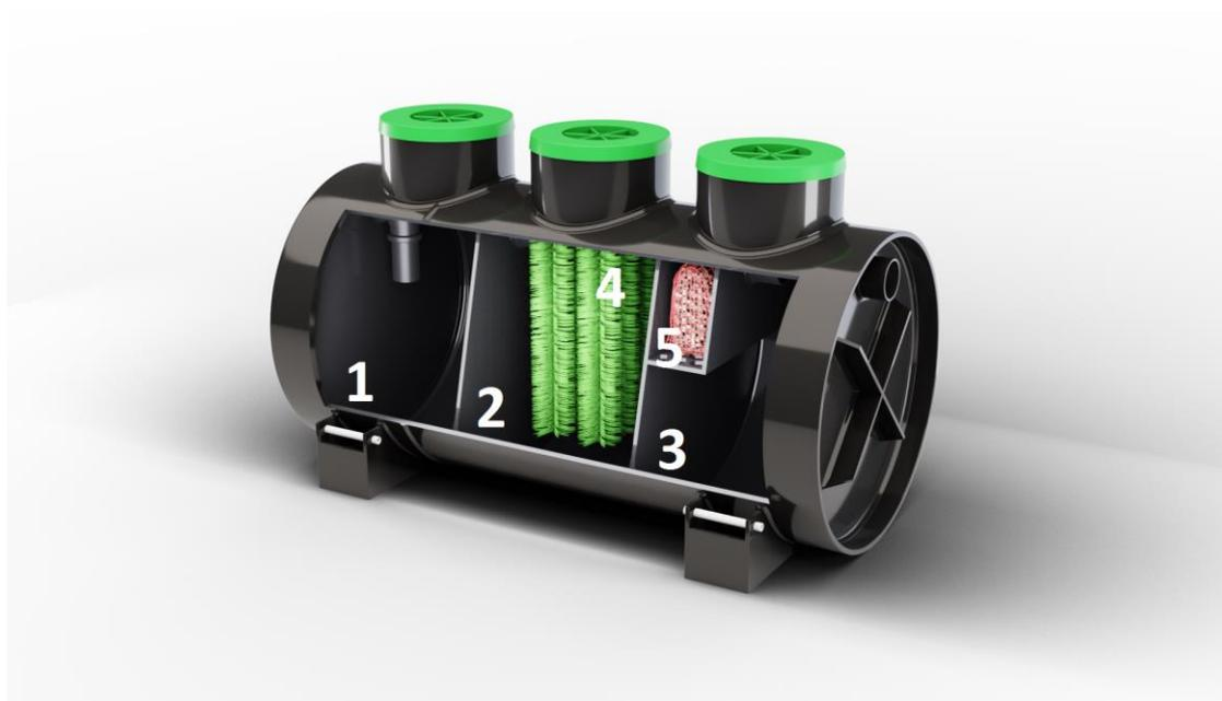
Рис. 2 Устройство септика «Эко-Л» моделей 5-12.
